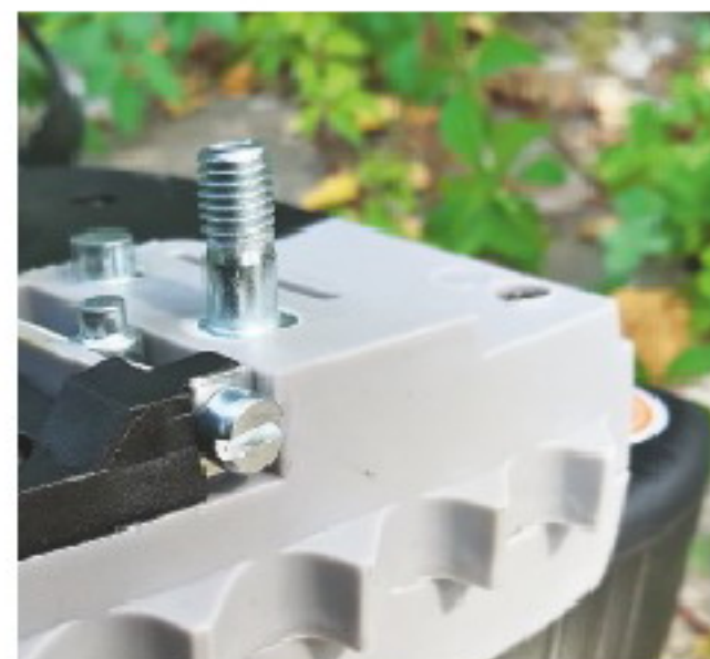
Механизм натяжения цепи и пластмассовые зубья в новой версии пилы.
