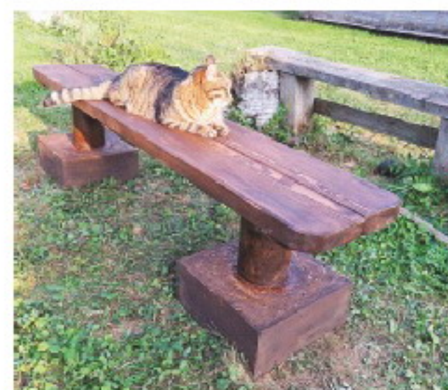
Устанавливаем ножки на нужном расстоянии, вес каждого «тапка» получился более 30 кг, можно было и тоньше сделать.
