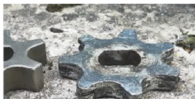
Сравнение новой и старой звёздочек привода цепи.
