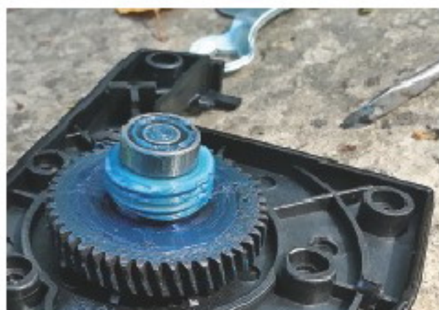
Металлическая шестерня новой версии пилы Sturm CC9916.
